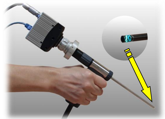
HiSpec1 と工業用内視鏡による撮影 (上部は、側視用のミラーチューブ)
