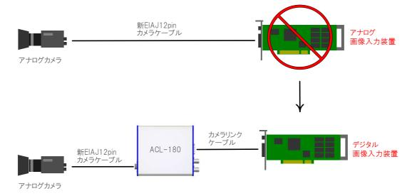
アナログ画像入力装置をデジタル画像入力装置に更新する際に本ユニットを使用すると、従来使用していたアナログカメラを変更せずに画像処理システムを構築することができます。
