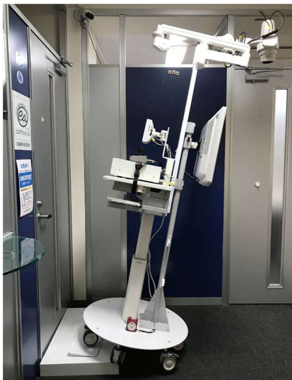
操作者側傾斜アームおりたたみ、 カート最長の状態TEST
